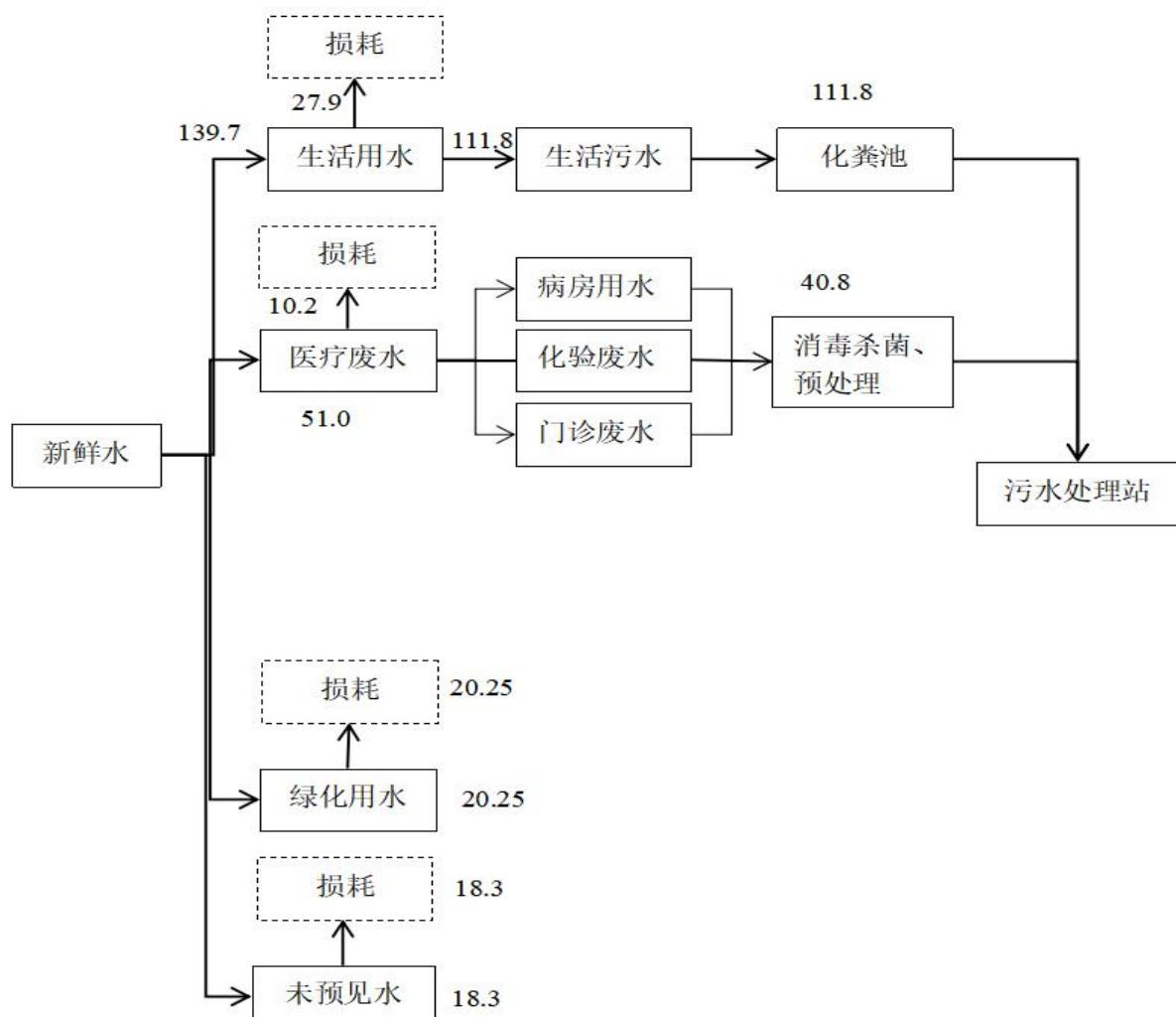
图 1-2 项目水平衡图 单位:  $\text{m}^3/\text{d}$
