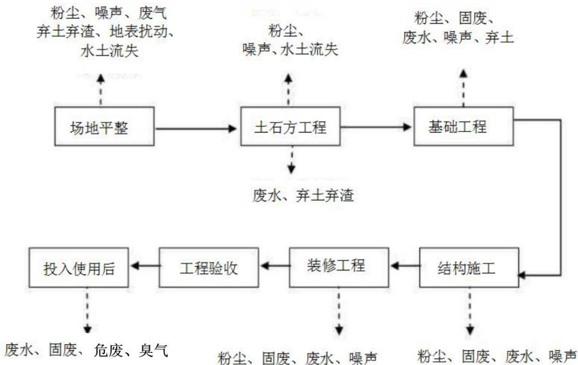
图 5-1 项目施工流程及产污位置图
